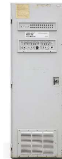
FIGURA 9 – Parte externa do MPI, o Primeiro Comutador de Pacotes
