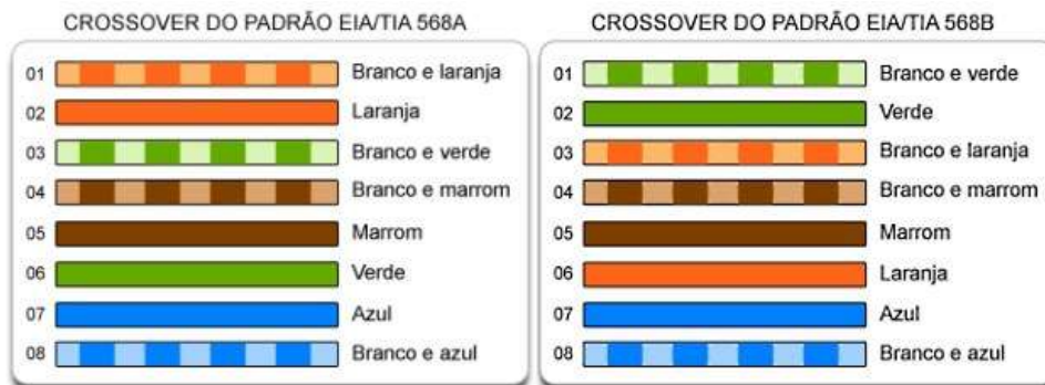
FIGURA 43 – Ligação de um Cabo Crossover
